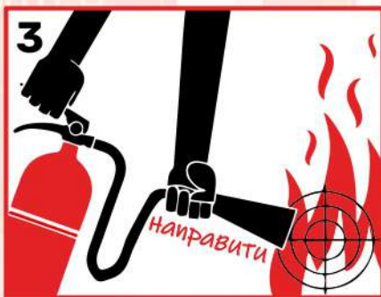
Направити розпилювач вогнегасника на вогнище
